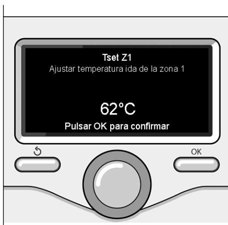
Modificar la temperatura agua caliente calefacción
