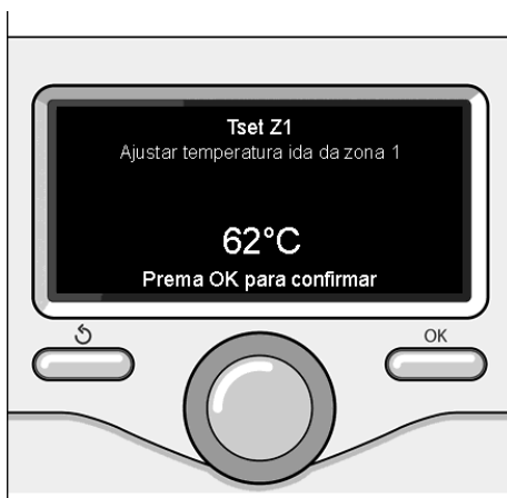
Modificação temperatura água quente aquecimento
