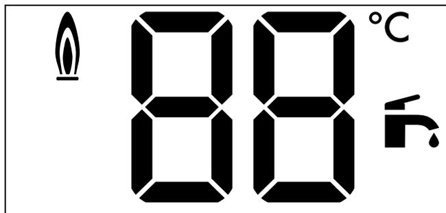
La pantalla básica muestra la temperatura, el modo de funcionamiento e información adicional.
