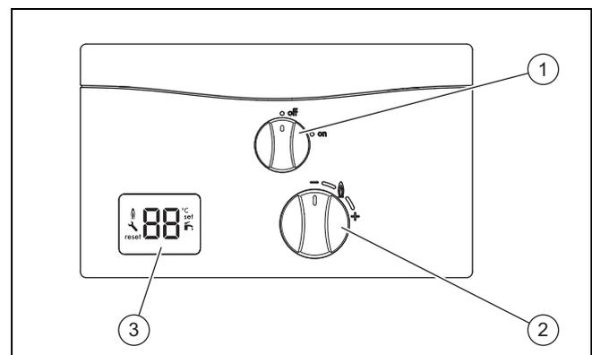
1 Interruptor de encendido/apagado
