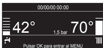
Uma vez completo o procedimento de arranque, o display mostra a temperatura ajustada para aquecimento e água quente sanitária (configuração display: caldeira base). A caldeira pede ajustes de data, hora e língua. Proceder como indicado no parágrafo MENU UTILIZADOR
