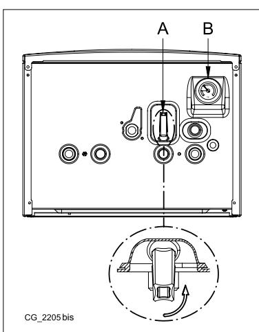
**AV** La caldera está dotada de un presóstato hidráulico que no permite el funcionamiento de la caldera en caso de falta de agua.
